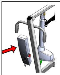
Fijar la caja de control con la ayuda de los dos tornillos.
