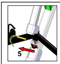
Desmontar el clip que mantiene la percha, y levantar la pluma. Fijar la cabeza del actuador con la pluma mediante el clip.
