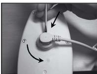
Introducir un destornillador en la ranura para desbloquear el anillo exterior y girarlo 90° en el sentido contrario a las agujas del reloj. Se liberará el conector.
