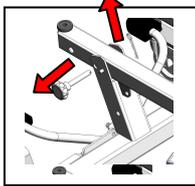
Desmontar el pasador, sacar la rosca con el eje y levantar el mástil.
